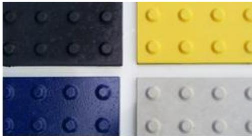
Ladrilho hidráulico, direcional, na cor preta, espessura tátil 5 mm, formato: redondos com relevos, espessura da base: 20mm, chanfrada, placas medida de 250 x 250 mm, composição: cimento e areia, peso:2,850 kg.
